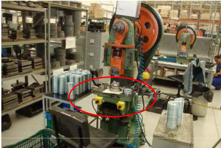
Foto 1 – Prensa excêntrica mecânica de engate por chaveta sem proteção da zona de perigo
