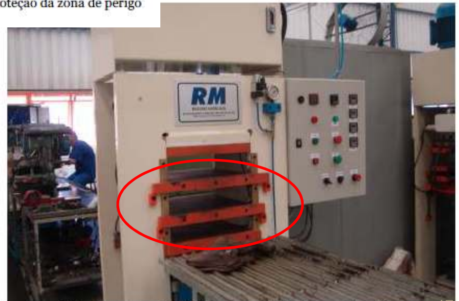
Foto 3 – prensa hidráulica sem proteção da zona de perigo
